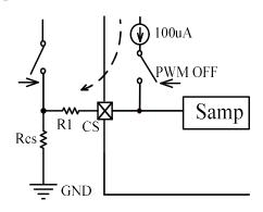
SP6681 提供了一种自适应的逐周期变化的 OCP 补偿方法,如下图所示。每个周期 OCP 的最大阈值电压 Vth\_Pk 为 0.84V。在 PWM 关断状态下,100uA 电流从 CS 引脚流出,通过 R1 和 Rsense 产生电压。最后由叠加的 CS 峰值钳位电压阈值调节。
