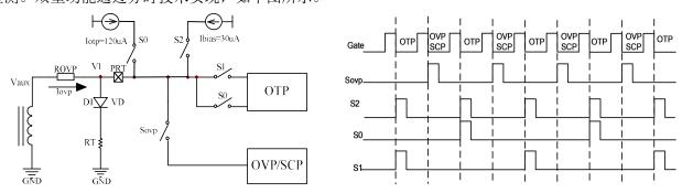
当 S2= "1"时,存在 30uA 偏置电流流出,即 S0= "1"或 S1="1",外部 OTP 检测时,当开关控制信号 S1="1"时,30uA 电流从 PRT 引脚流出,当开关控制信号 S0= "1"时,除 30uA 外,还有 120uA 电流从 PRT 引脚流出。所以 S1="1"时 PRT 引脚电压 V1(s0)为:
