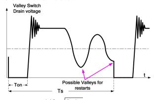
反激过程后,漏极电压的振荡频率约为  $1/2\pi\sqrt{L_pC_d}$  ,其中 Lp 为变压器的一次绕组的初级电感量, Cd 为漏极节点电容。在 PRT 引脚典型的检测水平固定在 85mV(典型)。当 PRT 电压下降低于 85mV 时,通过检测可能的"谷底"来识别退磁信号。
